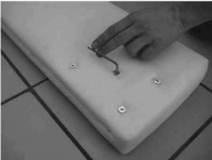
**2.** Schrauben Sie die Senkkopfschrauben mit dem mitgelieferten Innensechskantschlüssel aus den Wangen / Kopfteil.
