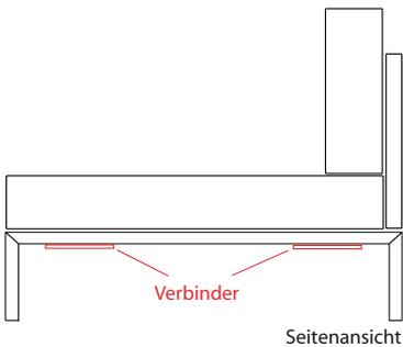
1. Die Verbinder befinden sich unter den Querstreben des Metallrahmens.
