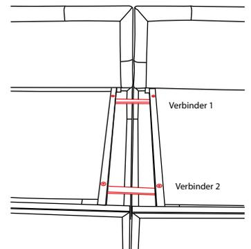
4. Um zwei Elemente zu verbinden, benötigen Sie zwei Verbinder, siehe Abb. oben.
