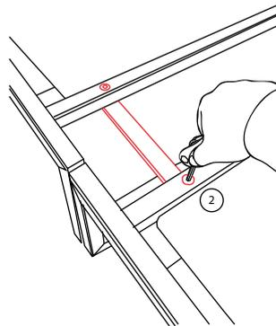
3. Verschrauben Sie nun beide Elemente, mit Hilfe des Verbinders, indem Sie beide Schrauben (1;2) fest anziehen.
