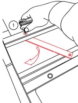
2. Lockern Sie die Schraube (1), sodass Sie den Verbinder um 90 Grad nach außen drehen können. Die Bohrung vom zweiten Element und das Gewinde vom Verbinder müssen übereinanderliegen.
