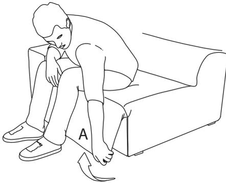
Greifen Sie mit einer Hand an die untere Kante der Fußklappe (A) und ziehen diese nach vorne hoch. Die Funktion ist mit einer Feder ausgestattet, die die Fußklappe von selbst nach oben drückt, sobald der Auslösepunkt erreicht ist.
