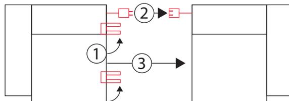
Wenn zwei Elemente mit motorischem Sitzauszug miteinander verbunden werden sollen müssen erst die Verbinderratschen nach außen gedreht werden (1). Dann die Elemente so weit zusammenschieben, dass die beiden Stecker (2) miteinander verbunden werden können. Jetzt die Elemente zusammenschieben (3).
